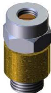
Válvula reguladora de fluxo é recomendada para uso junto a válvula solenoide controlando a saída de ar das câmaras do cilindro. Possui silenciador de bronze sinterizado integrado.
